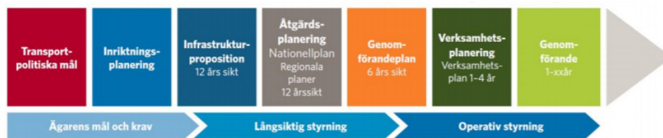
Figur 2-1 Planeringsprocess för transportinfrastrukturen. Från ägarens mål till genomförande. Källa: Trafikverket (2017) Trafikverkets genomförandeplan för åren 2018–2023
